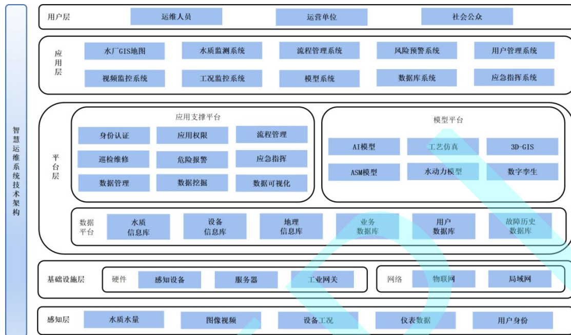
图 1 市政污水处理厂智慧运维系统技术架构图
